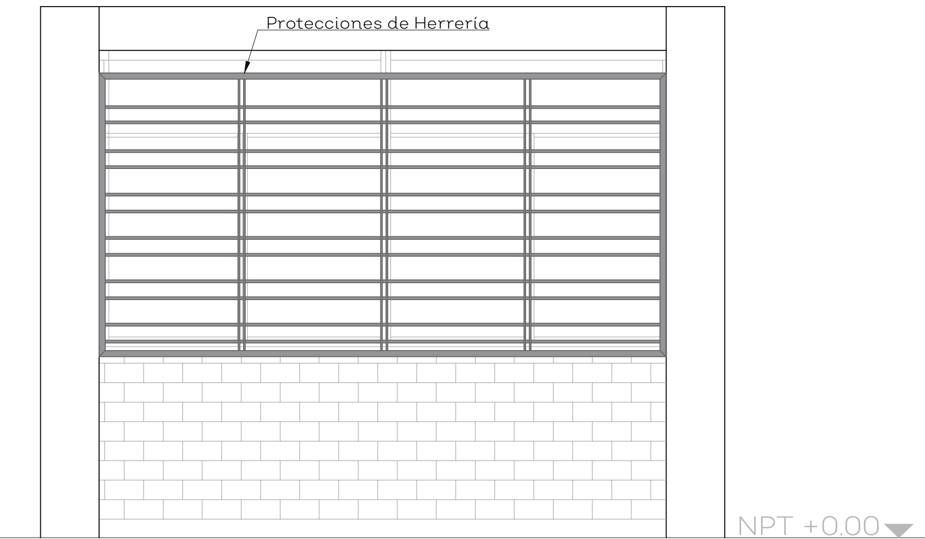
02 PROTECCIÓN DE HERRERÍA - ALZADO AULAS 120
