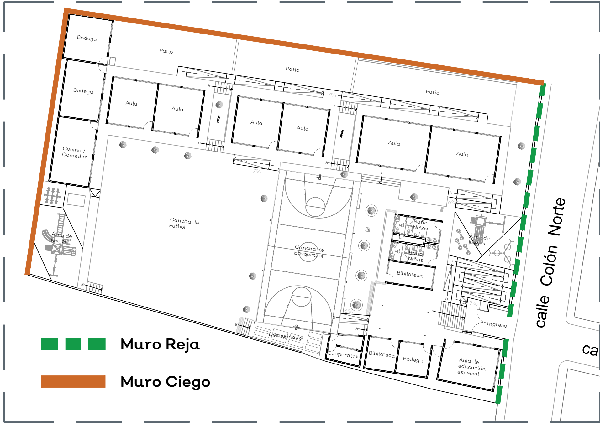
01 PLANO DE CONJUNTO MUROS
