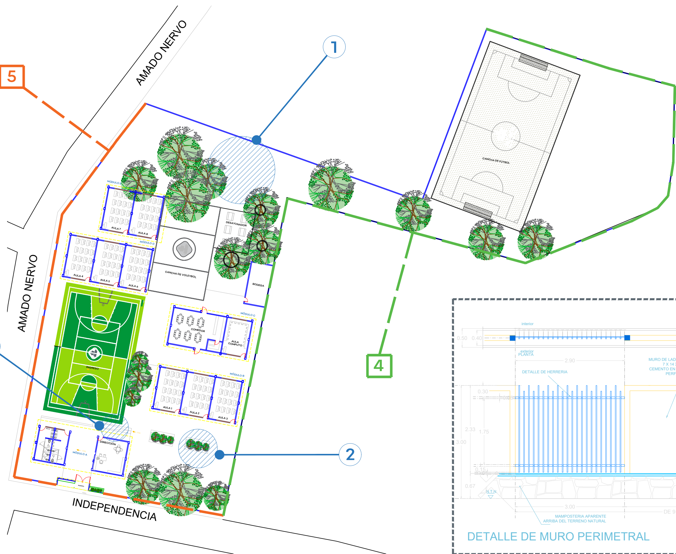
04 PLANTA DE UBICACION DE MUROS PERIMETRALES S/E
