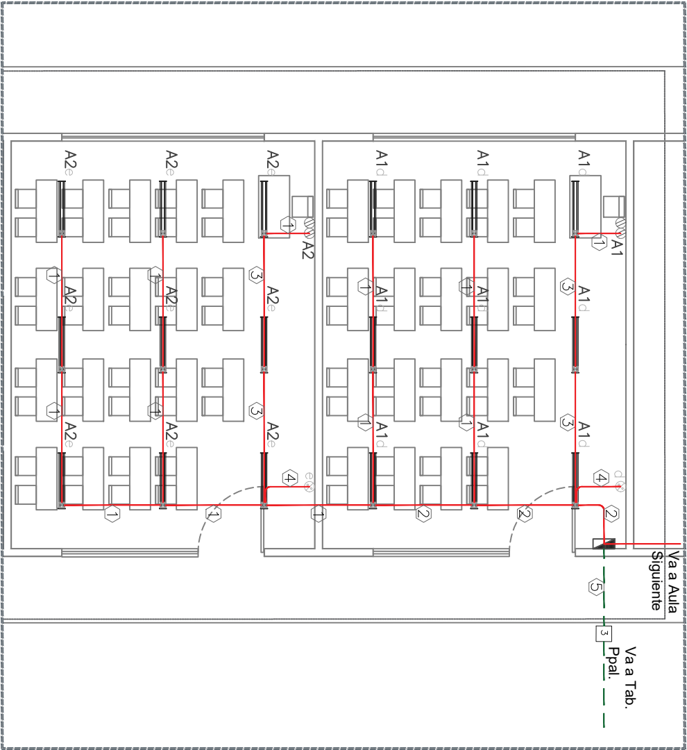
01 INSTALACIÓN ELÉCTRICA E ILUMINACIÓN AULAS TIPO
