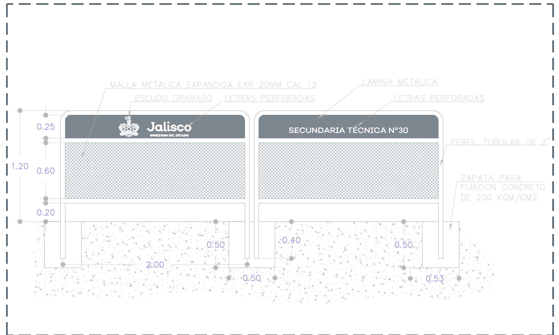
07 DETALLE BARRERA DE PROTECCIÓN-INGRESO 1:25
