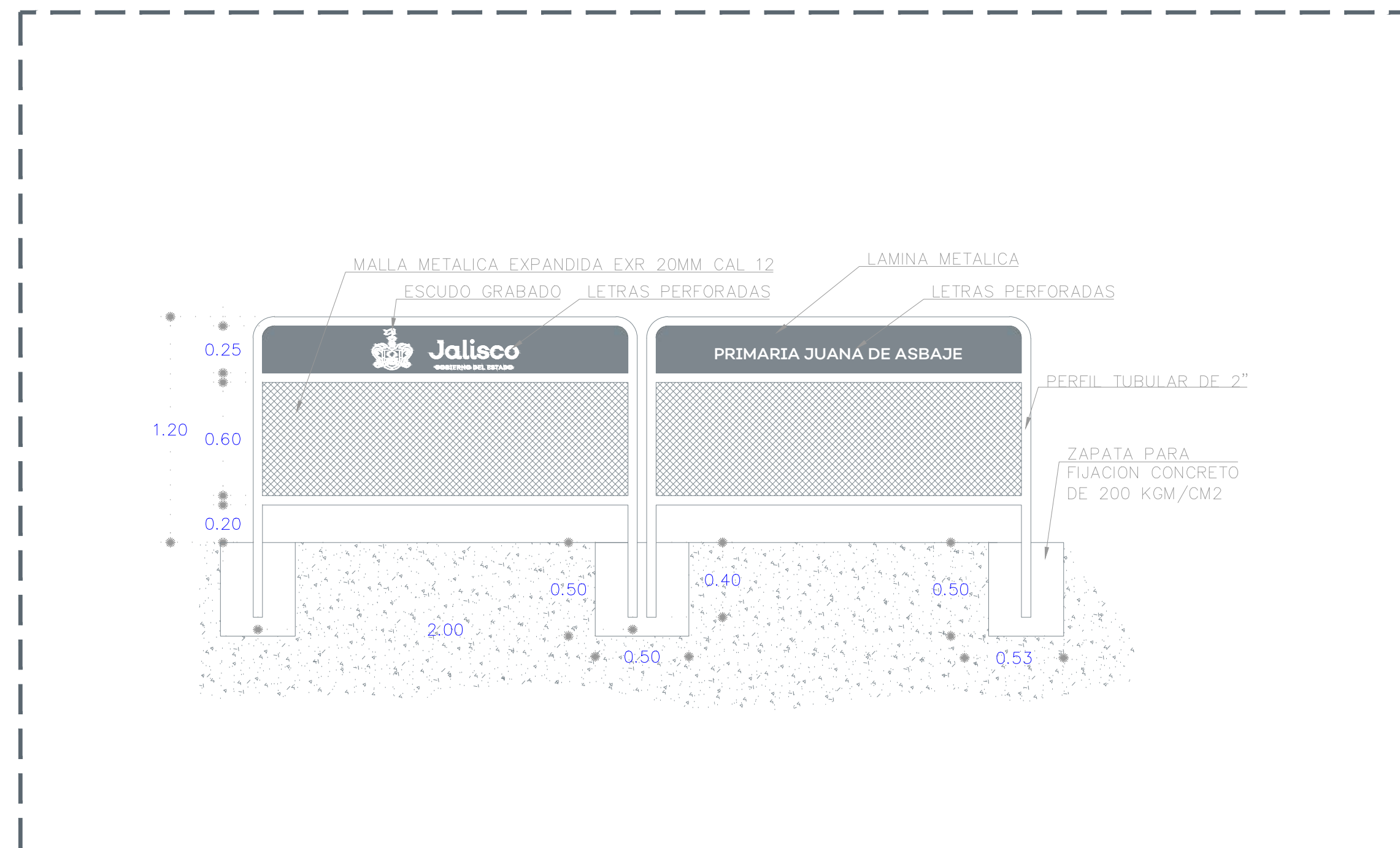
07 DETALLE BARRERA DE PROTECCIÓN-INGRESO 1:25
