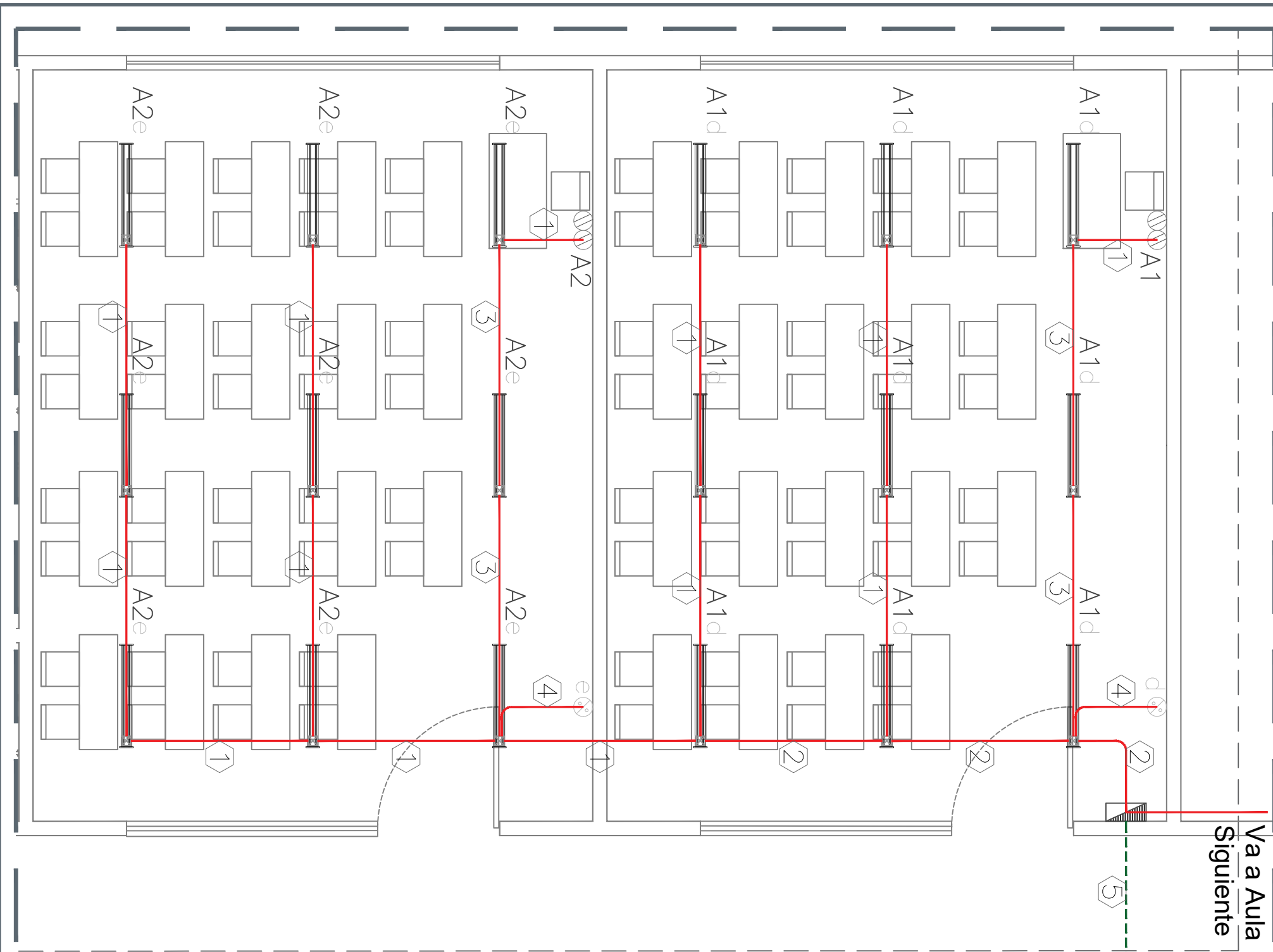
01 Instalación eléctrica e iluminación aulas tipo 150
