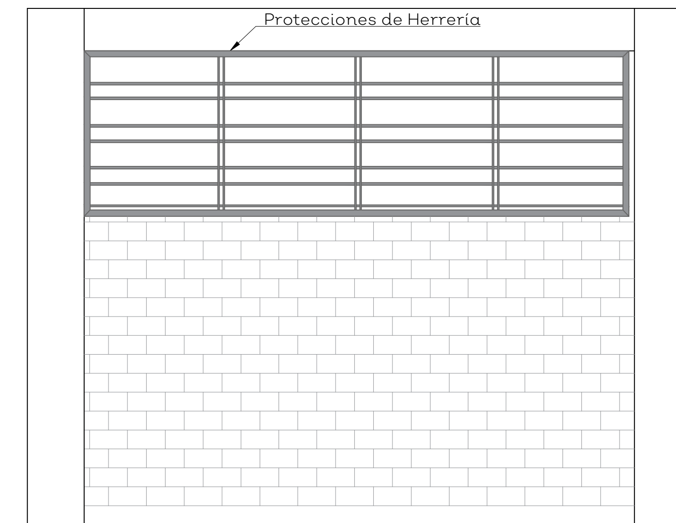
03 PROTECCIÓN DE HERRERÍA - ALZADO BAÑOS 120
