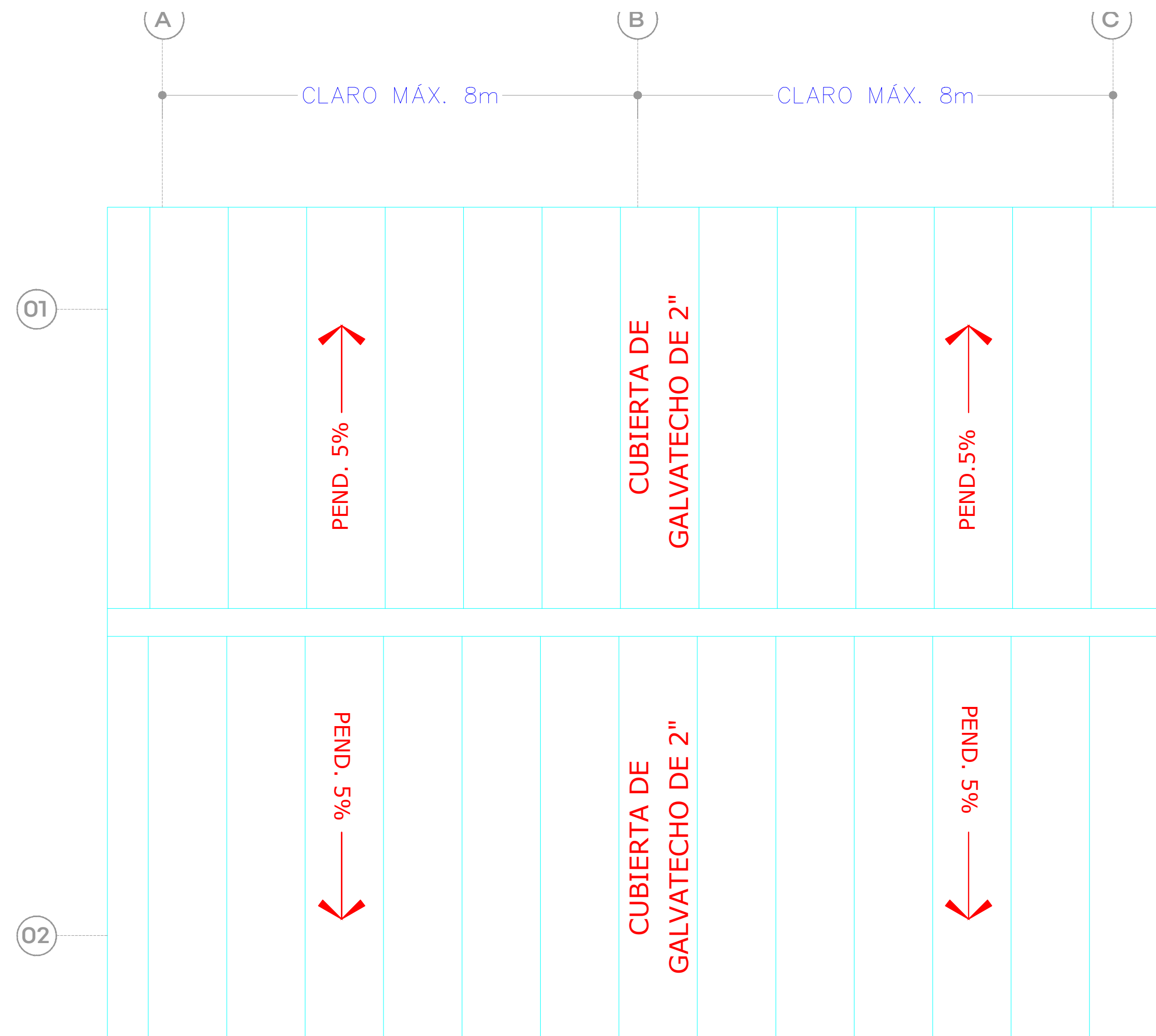
02 PLANTA DE CUBIERTA 1:50
