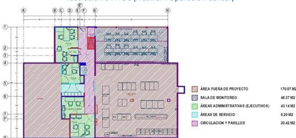
Ilustración 64 NOC (Network Operación Center)
